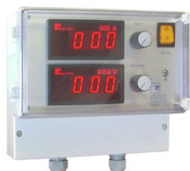
Bedieneinheit 200-D im Wandgehäuse mit großen Digitalanzeigen
