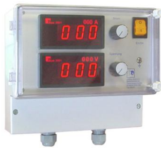
Bedieneinheit 200-D im Wandgehäuse mit großen Digitalanzeigen
