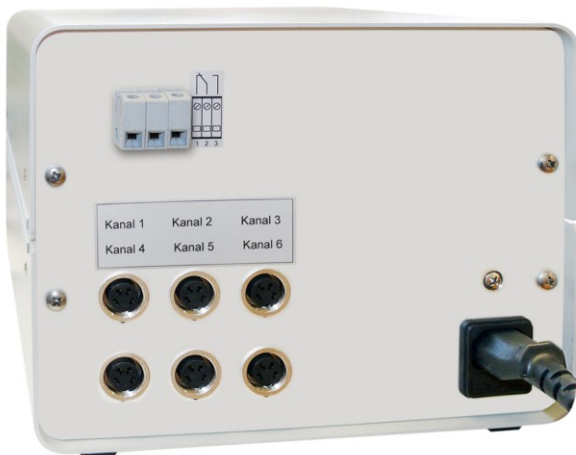
Dosierstation pe6180-6, Rückseite
